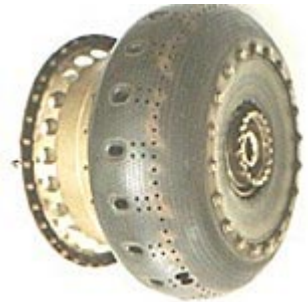
Câmara de combustão
