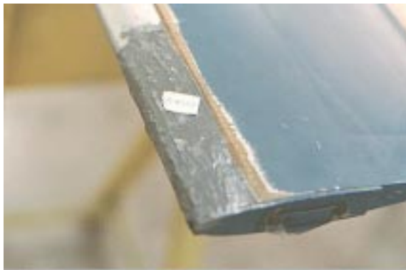
Tentativa de reparo de uma pá acidentada.
