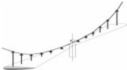
Diagrama de sustentação de um rotor sem torção.
