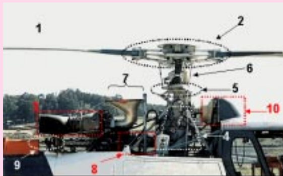
Figura 1-2 Principais Partes Constituintes de um Helicóptero Moderno (HB-350B Esquilo)
